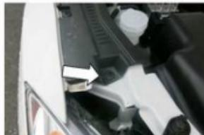
1. Удалить пистон крепления пластика к кузову, (Рис.1).
