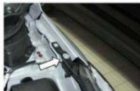
2. Установить кронштейн крыла, как показано на рисунке. Штатный болт крепления фары заменить болтом М8х30. Затянуть болт крепления крыла ключом №10 с усилием 9 Нм; болт крепления фары ключом №13 с усилием 23 Нм.
