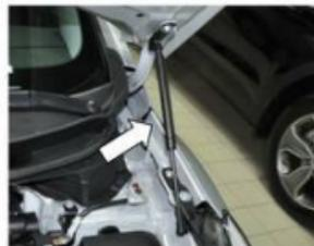
4. Прокачать амортизатор (упереть в твердую поверхность, несколько раз полностью сжать и отпустить).
